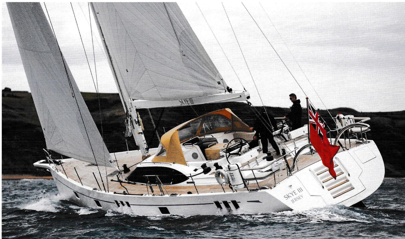
Lungo 19,05 metri fuori tutto, il nuovo Oyster 595 sarà presentato al salone di Düsseldorf 2023. Si distingue per la capacità di navigare con equipaggi ridotti, formati anche soltanto da una coppia grazie all'organizzazione del piano di coperta e ai sistemi idraulici gestibili dal pozzetto centrale e alle eliche di manovra a prua e a poppa di serie. Può permettersi crociere oceaniche intorno al mondo con familiari e amici, ospitati nei raffinati e accoglienti interni che
